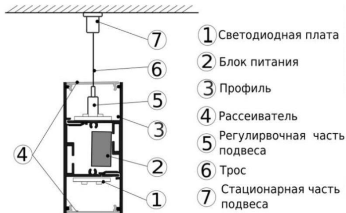
Рис. Монтаж подвесного светильника на потолок
