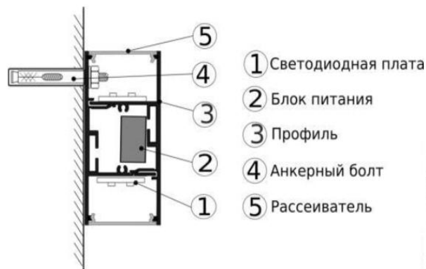
Рис. Монтаж накладного светильника на потолок
