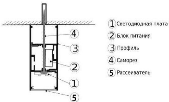
Рис. Монтаж накладного светильника на потолок
