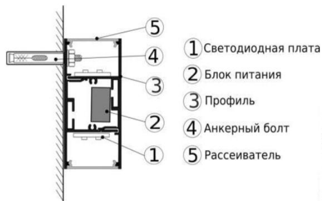
Рис. Монтаж накладного светильника на стену
