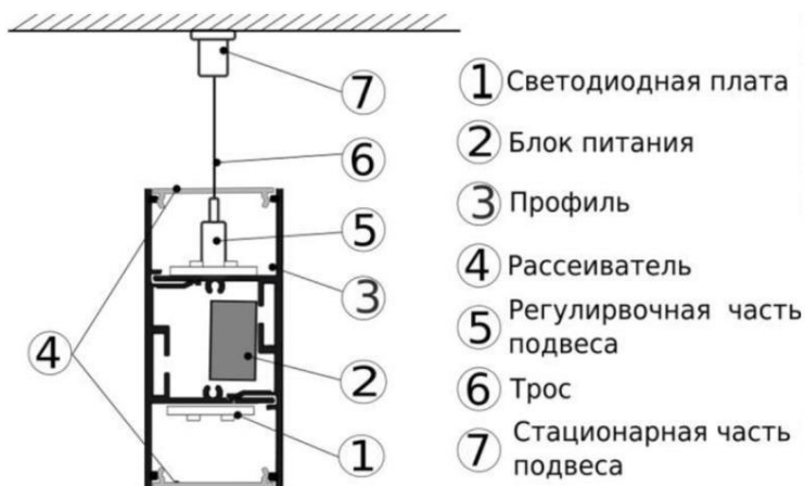
Рис. Монтаж подвесного светильника на потолок
