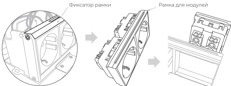
Для снятия модуля необходимо выкрутить винты фиксатора и достать рамку с модулями. Для извлечения модуля из рамки надавите на четыре упора.
