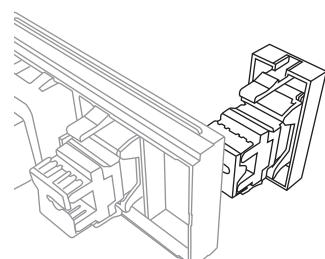
Для снятия модуля необходимо выкрутить винты фиксатора и достать рамку с модулями. Для извлечения модуля из рамки надавите на две защелки.
