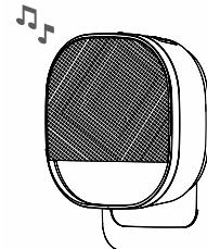
4. Если ресивер не срабатывает при нажатии кнопки звонка, синхронизируйте их частоту работы. Для этого необходимо очистить память ресивера зажав клавишу «Выбора мелодии» на 20 секунд.
