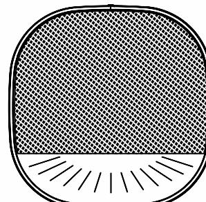
11. Монтаж кнопки звонка на стену осуществляется с помощью двухстороннего скотча или саморезами.
