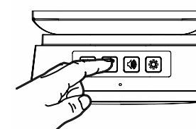
5. Затем необходимо вынуть ресивер из сети и установить его заново, и нажать на клавишу на кнопке звонка в течение 120 сек. При правильном подключении прозвучит мелодия.
