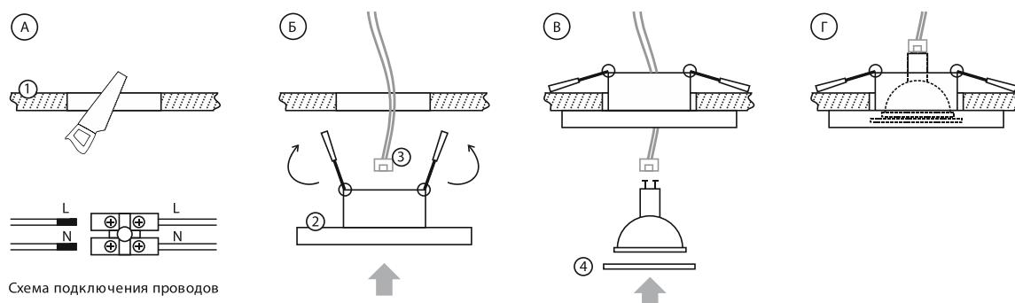
Схема подключения проводов
